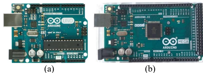
Fig. 4: CDUs: (a) Arduino Uno, (b) Arduino MEGA.
