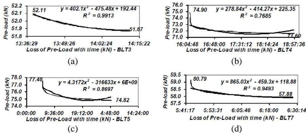
Fig. 4 Loss of Pre-load with Time. (a) Bolt-3, (b) Bolt-4, (c) Bolt-5, (d) Bolt-7.
