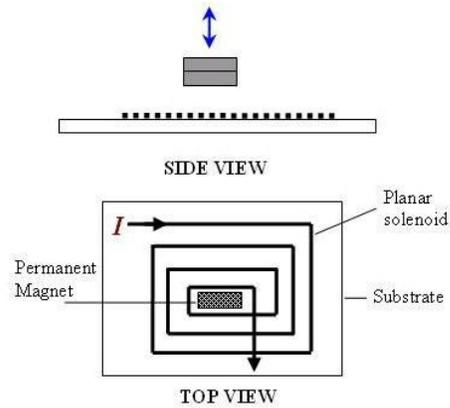
Fig. 3: Planar magnetic microactuator.
